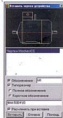
Рис. 3. Вставка электрического устройства в сборочный чертеж
